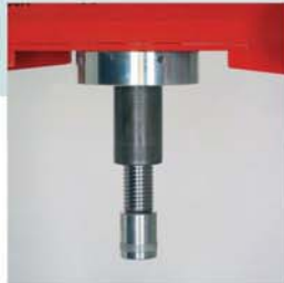
پیچ دستی برای سریع نزدیک شدن بر روی کار و تنظیم دقیق.
