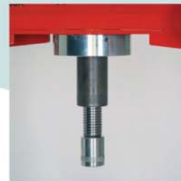
رابط پیچی دستی، برای سریع نزدیک شدن دستی و تنظیم دقیق.
